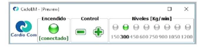
Este software corre en cualquier PC con sistema operativo Windows o Linux y tiene comando bidireccional con el cicloergómetro marca Cardio Com. De esta forma, desde la PC se puede manejar la resistencia de la bicicleta, pero a la vez, si la bicicleta es comandada de forma manual desde su módulo de control, el software refleja el nivel de resistencia en el que la misma se encuentra.
